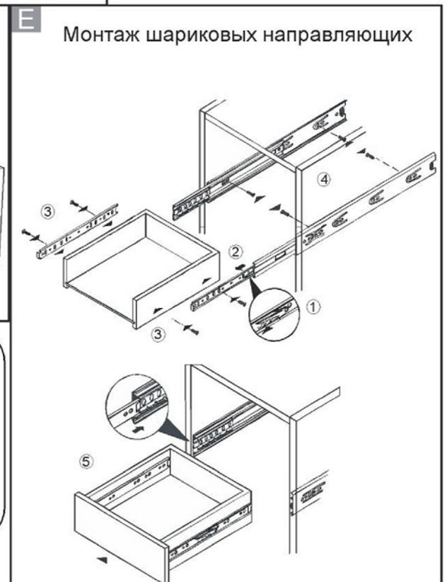
**Е.** Перед установкой направляющие нужно разъединить. Для этого стопор правой направляющей следует поднять вверх, а левой – опустить вниз. Закрепить направляющие на боковинах изделия согласно наколкам саморезами 3,5x16. Затем соединить направляющие, вставив друг в друга (произойдет щелчок)
